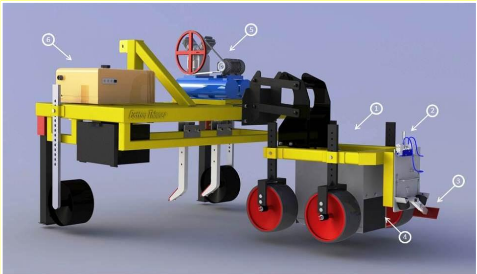
Şekil 3.1. Prototip seyreltme makinasının genel görünüşü (1. Karanlık oda, 2. Pnömatik silindir, 3. Seyreltme organı, 4. Encoder, 5. Kompresör, 6. Jeneratör).
