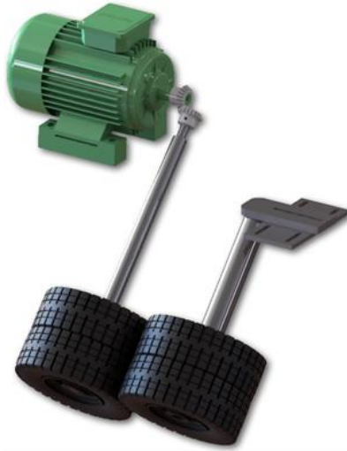
Şekil 3.28. Tutucu tekerleklerin konumu ve tahriki
