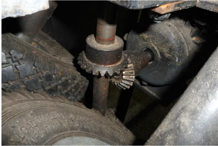
Şekil 4.2. Sap kesici bıçak ve kapsül kesici testereye hareket iletimi
