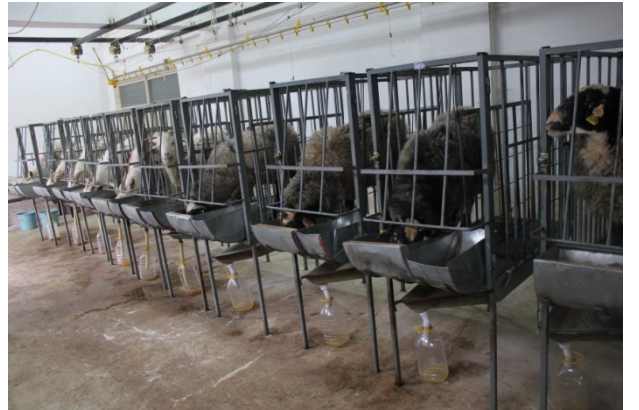
Ek Resim 2. Denemede kullanılan metabolik kafesler (ayak yüksekliđi 70 cm, ayak üzeri yükseklik 100 cm, boy 120 cm, en 60 cm)
