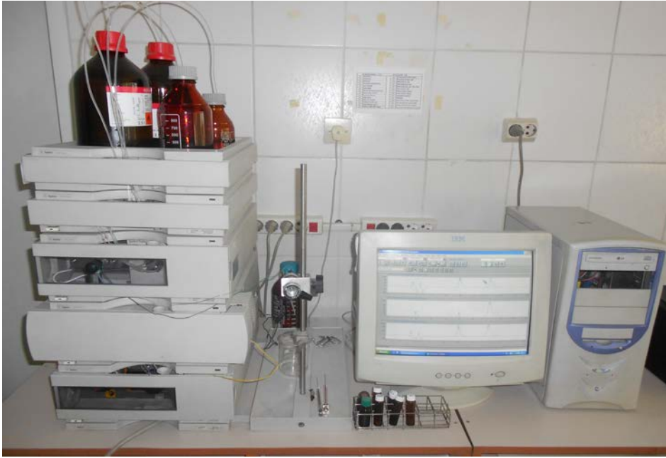
Şekil 2.2. Yüksek basınçlı sıvı kromatografi cihazı
