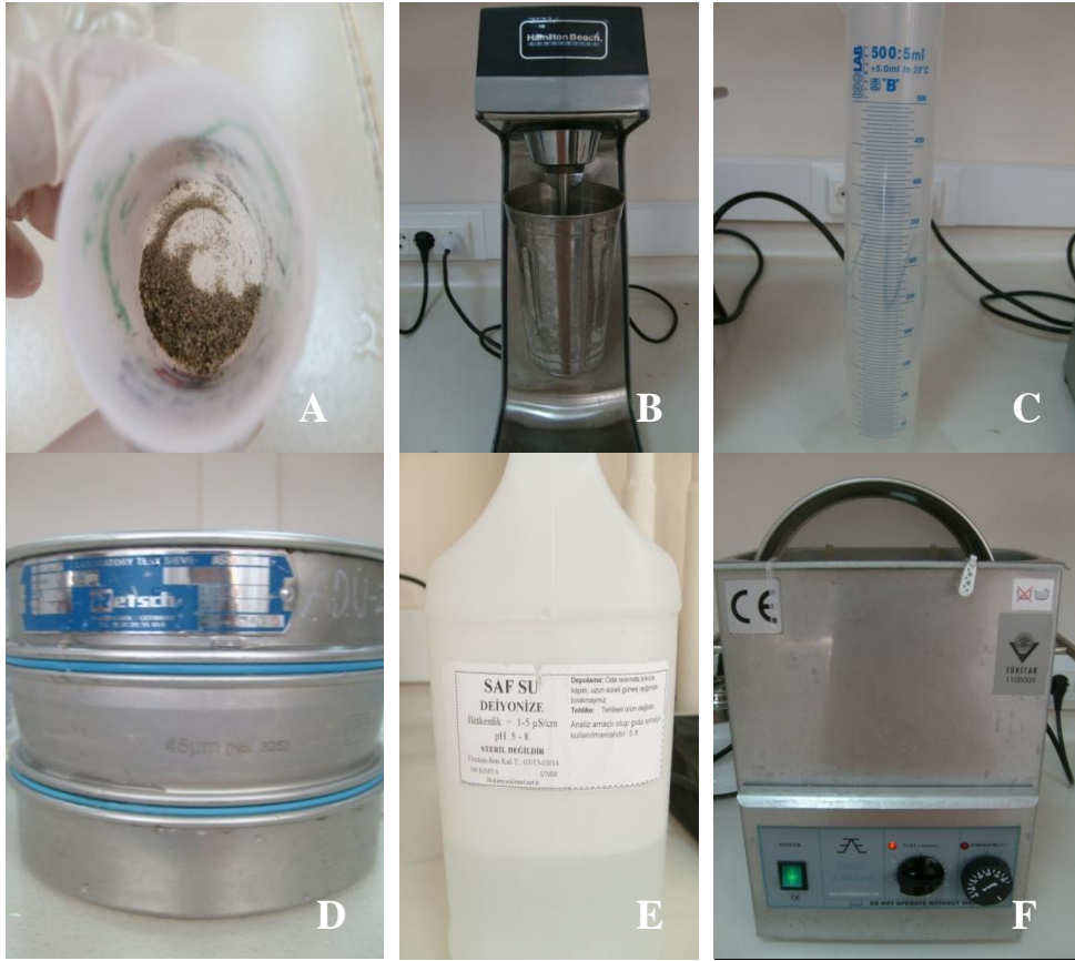
Şekil 3.8. Islak eleme yönteminde kullanılan materyal ve ekipmanlar; A: 1 gr tartılmış saksı toprağı; B: Toprak mikseri; C: 250 ml 0,525% NaOCI; D: 212 µm, 45 µm' lik elekler; E: Saf su; F: Ultrasonik banyo
