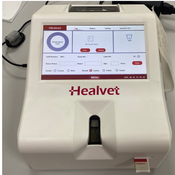
Resim 24. APTT, PT ve FİB analizinde kullanılan Healvet HV COA-7000 Koagulasyon Analizatörü.
