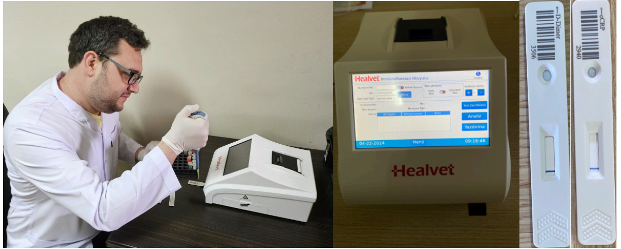
Resim 22. D-Dimer, cTnI, CRP, NT- proBNP testlerinin analizinin yapıldığı Healvet FIA 3000 cihazı.
