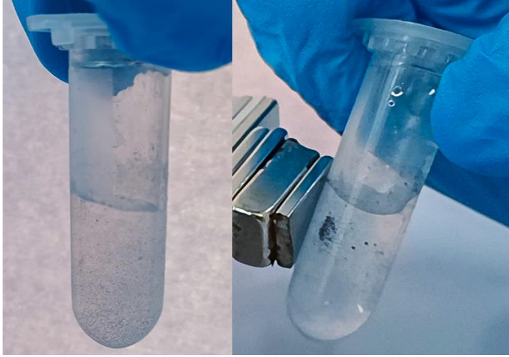
Resim 3. PPy-COOH/Ni manyetik mikromotorların mıknatıs ile ayrılması.
