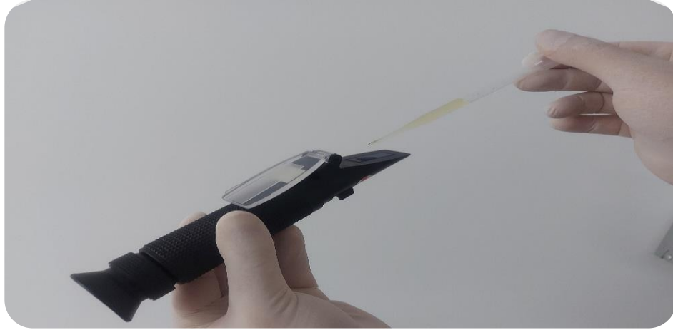
Resim 6. OER ile idrar özgül ağırlık ölçümü.
