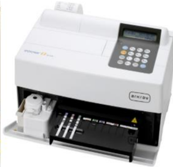
Resim 4. Tam kan sayımı için kullanılan Abacus Vet 5 ve biyokimya analizleri için kullanılan Spotchem EZ cihazı.
