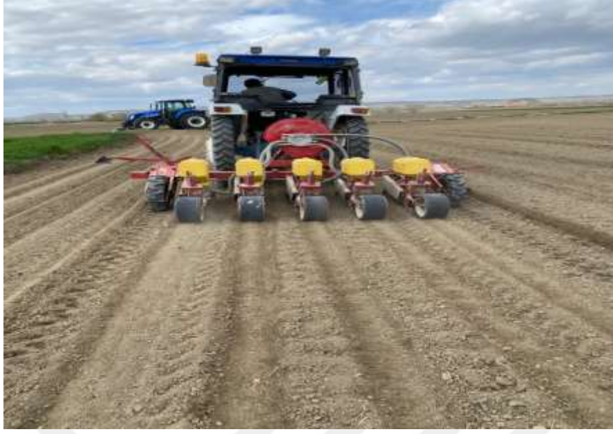
Şekil 3.3. Şeker Pancarının Pnömatik Mibzer ile Ekimi
