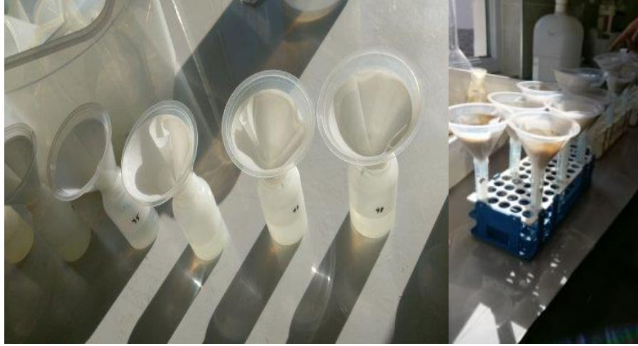
Resim 3.13. (Devam) Mikrodalga ünitesinde yaş yakma sonrasında makro ve mikro elementlerin AAS' de tespiti için yaprak süzüntülerini hazırlama işlemleri
