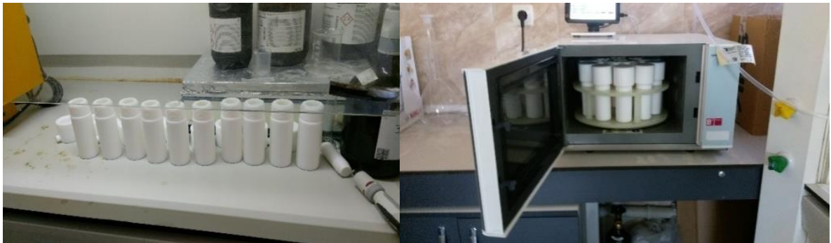
Resim 3.13. Mikrodalga ünitesinde yaş yakma işlemi
