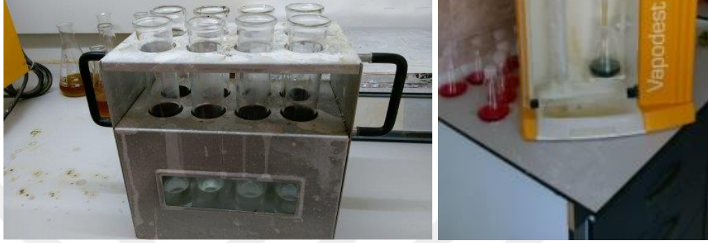
Resim 3.12. Yapraklarda azot tayininde kullanılan Kjeldahl yakma ve destilasyon ünitesi
