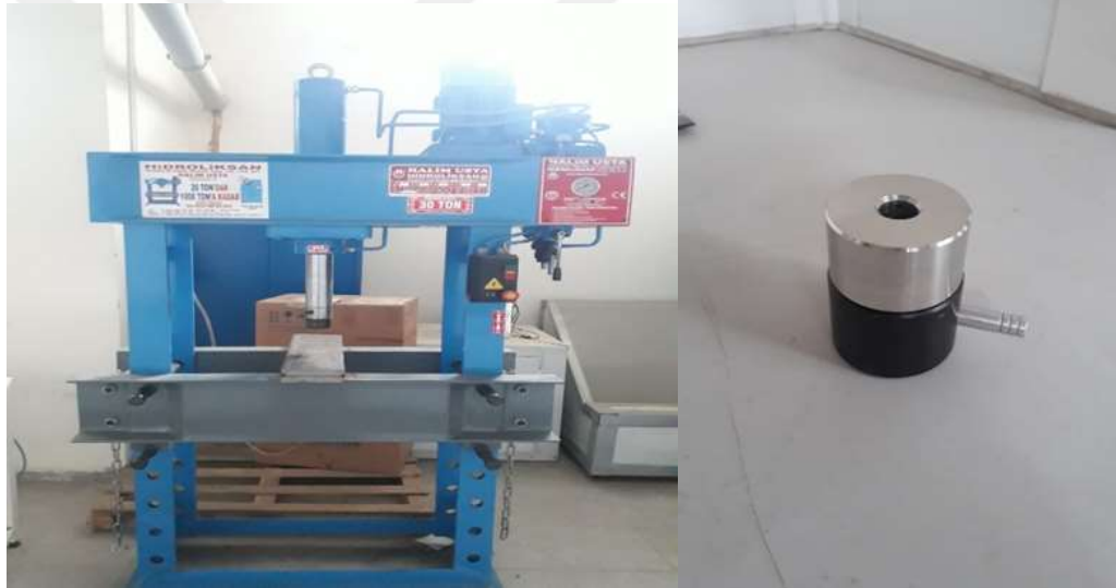
Şekil 4.5. Hidroliksan marka pres aleti ve boşaltılabilir pellet kalıbı
