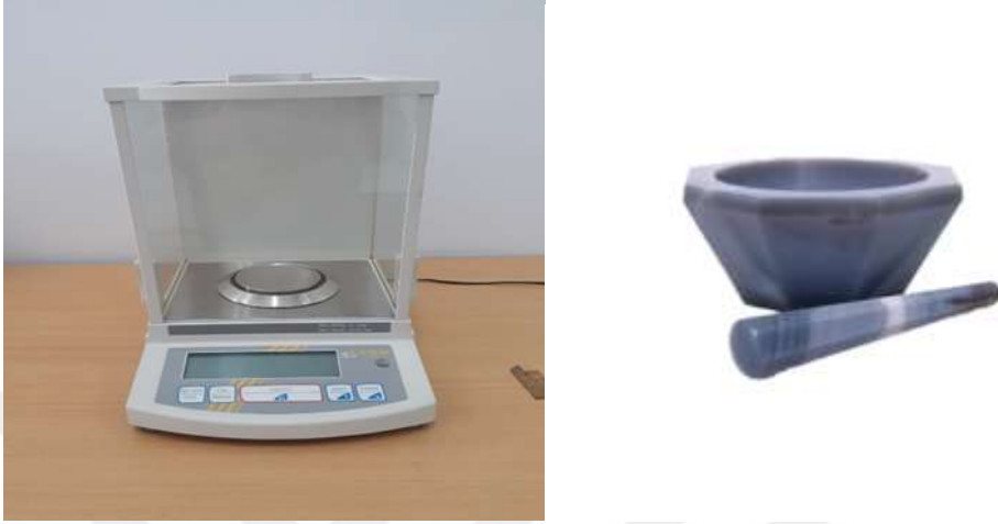
Şekil 4.1. Kern & Sohn GmbH marka hassas elektronik terazi ve agat havan görselleri
