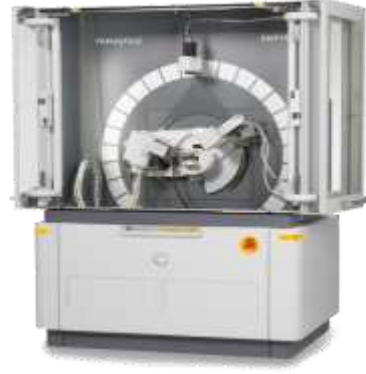
Şekil 4.9. Malzemelerin XRD metoduyla analiz cihazı
