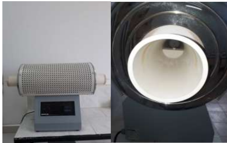
Şekil 4.4. Protherm marka kalsinasyon fırını
