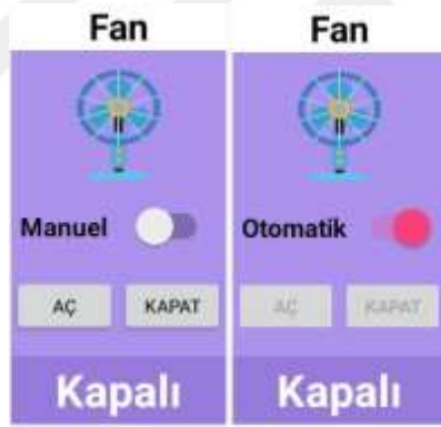
Şekil:5.35. Havalandırma fan kontrol durum göstergesi
