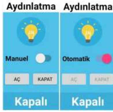
Şekil 5.32. Aydınlatma kontrol durum göstergesi
