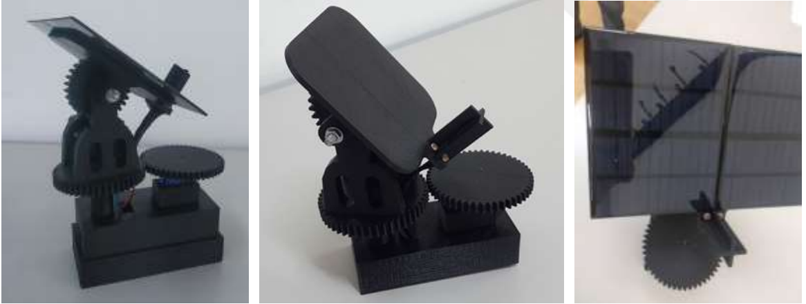
Şekil 5.21. Güneş takip sistemi
