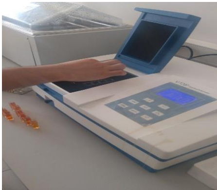
Resim 3.7. Spektrofotometre cihazı ile silajların SÇK, LA, NH 3 -N içeriklerinin belirlenmesi
