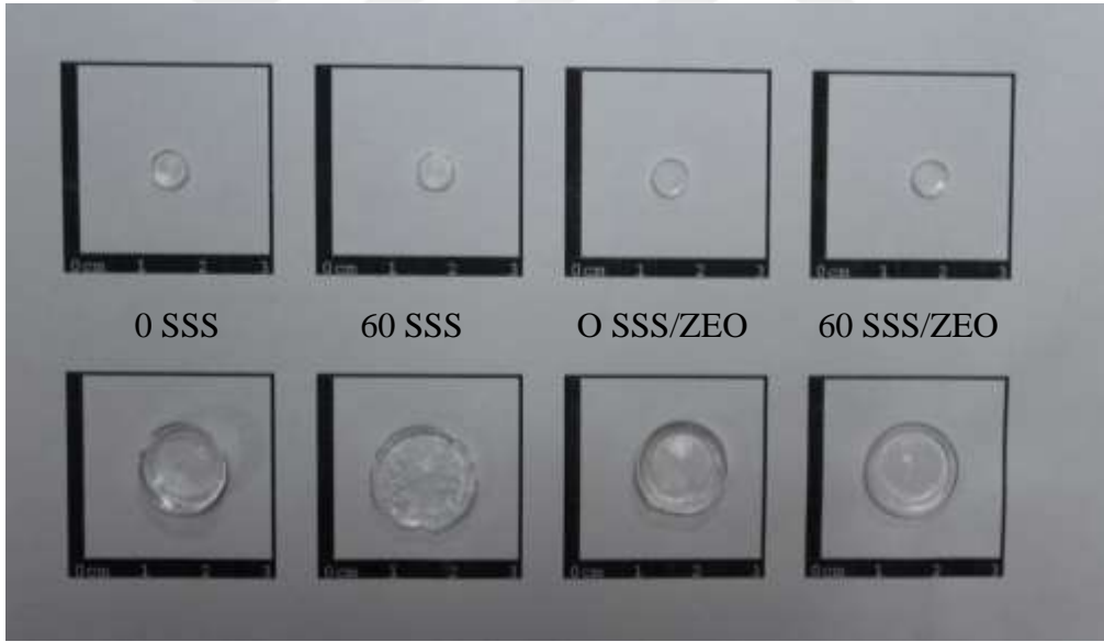
Resim 4.6. PrAm/SSS hidrojel ve PrAm/SSS/ZEO kompozit hidrojelinin kuru ve su soğurumu yapmış görünümleri.
