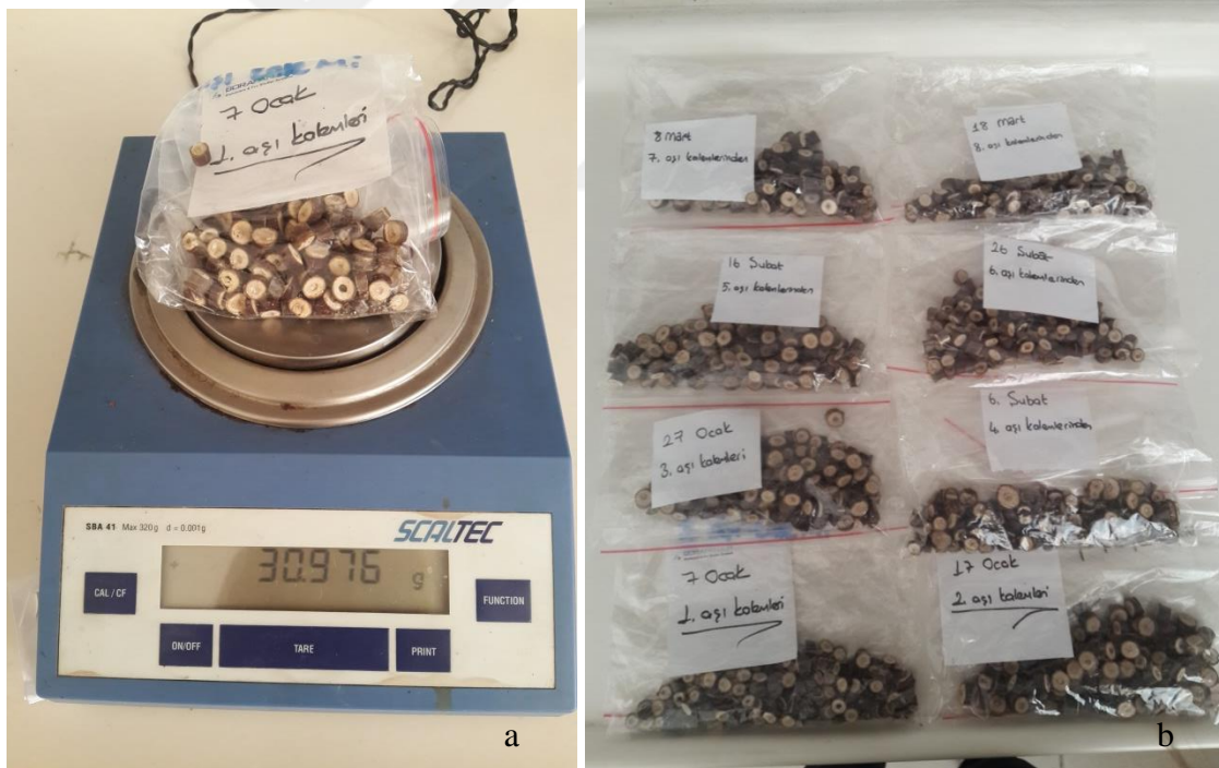
Resim 3.19. a) Etüvdeki örneğin hassas terazide kuru ağırlığına sabitlenmesi kontrol edilirken b) Etüvde kuru ağırlıklarına ulaşmış örneklerin toz haline gelmeden önceki görselleri
