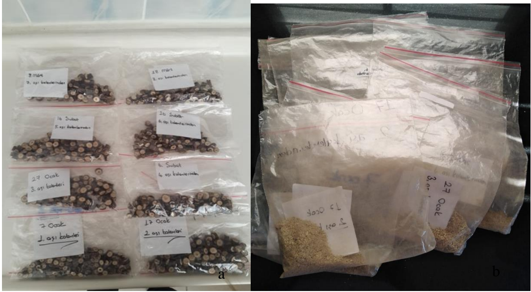
Resim 3.5. a) Kuru ağırlıklarına ulaşan örneklerin öğütülmeden önceki görselleri b) Kuru ağırlıklarına ulaşan örneklerin öğütülmüş halleri
