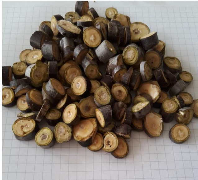
Resim 3.4. Örneklerin etüvde kuru ağırlıklarına ulaşmadan önceki parçalanması
