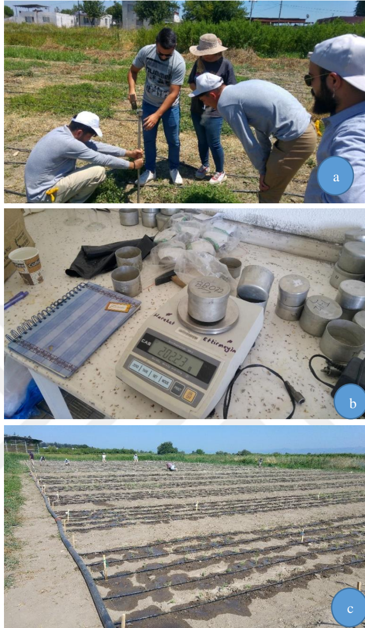
Resim 3.8. Gravimetrik yöntemle toprak örneği alınması (a: toprak örneklerinin sonda ile alınması, b: örneklerin tartılması, c: sulama işlemi).
