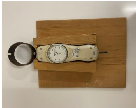
Resim 3.2. Tutunma kuvveti ölçümlerinde kullanılan mekanik el dinamometresi
