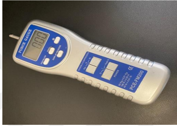
Resim 3.3. Meyve eti sertliği ölçümünde kullanılan dijital el penetrometresi
