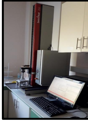
Resim 4. Zwick Roel Z0.5 sertlik analiz cihazı.
