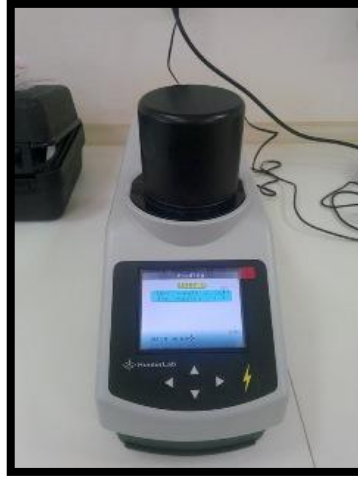
Resim 3. Colorflex EZ®, Hunter Lab Manual Version 1.2 renk analiz cihazı.
