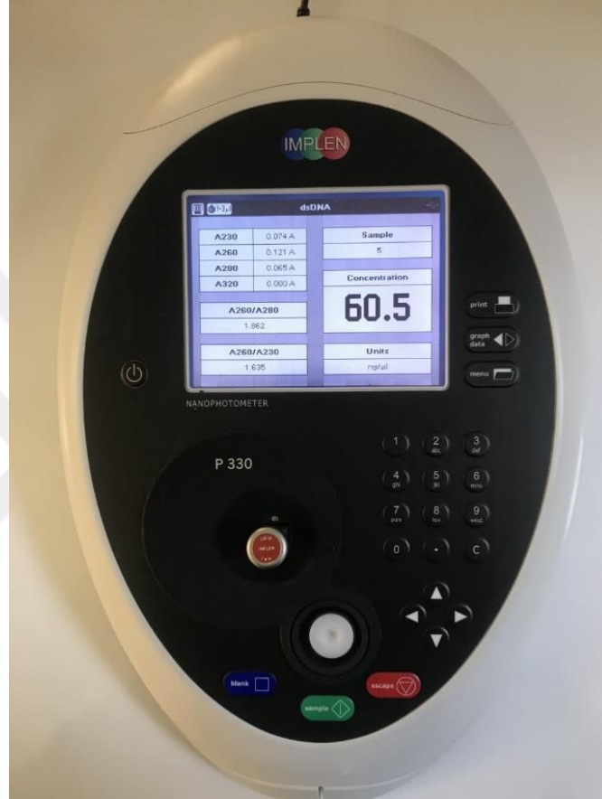
Resim 3.4. Nanofotometre ile DNA miktar ve saflık ölçümü.
