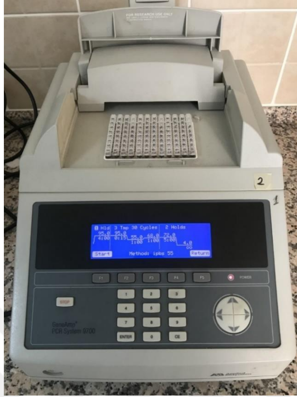
Resim 3.6. Örneklerin Thermal Cyler cihazına yerleştirilmesi.
