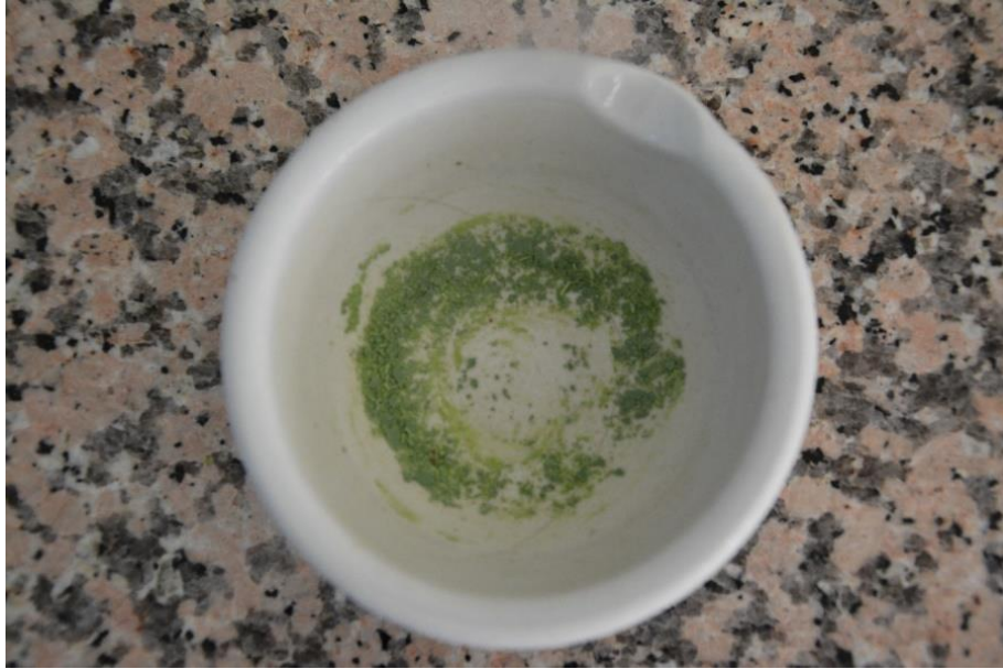
Resim 3.3. Örneklerin sıvı azotla havanda ezilmesi.
