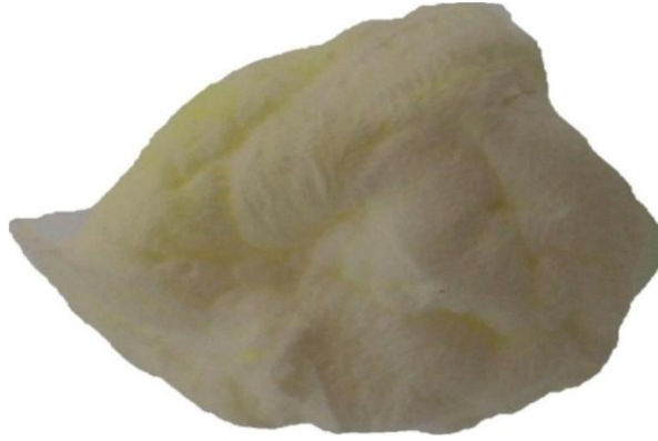
Resim 3.9. Erime ilerledikten sonra%12 PVA malzeme içeren özel bir yapay dolu tanesi
