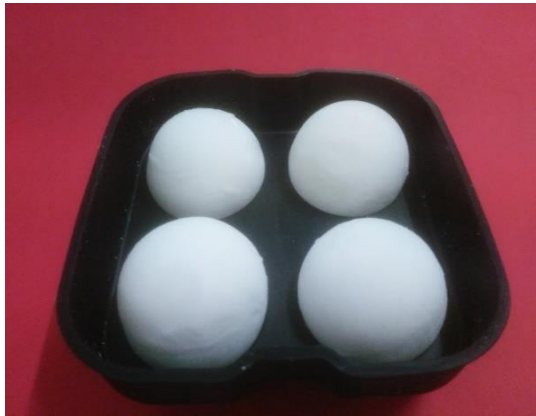
Resim 3.8. Bu çalışmada %12 PVA ile üretilen tipik yapay dolular
