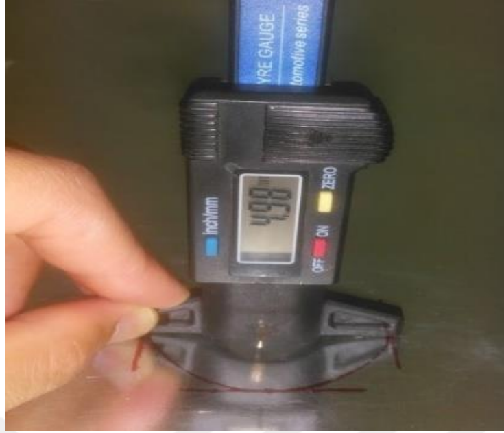
Resim 4.11. Çelik panel üzerinde oluşan çukur derinliği
