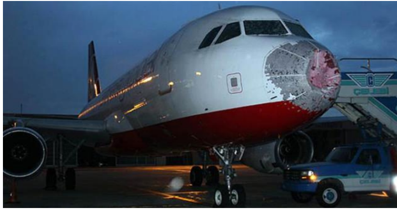
Resim 3.1. Dolunun verdiđi hasarlar ( https://www.havaforum.com/27-Temmuz-2017-Istanbulda-dolu-yađisi )
