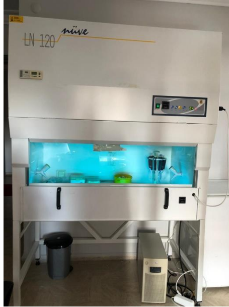
Resim 1. Nüve 120; Tüm örneklerin hazırlanması için kullanılan biogüvenlik kabini
