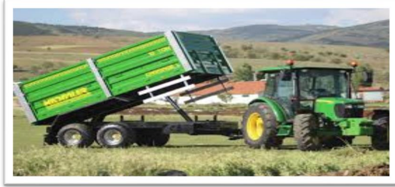
Şekil 5. Silaj taşıma hidrolik kasalı tarım arabası.
