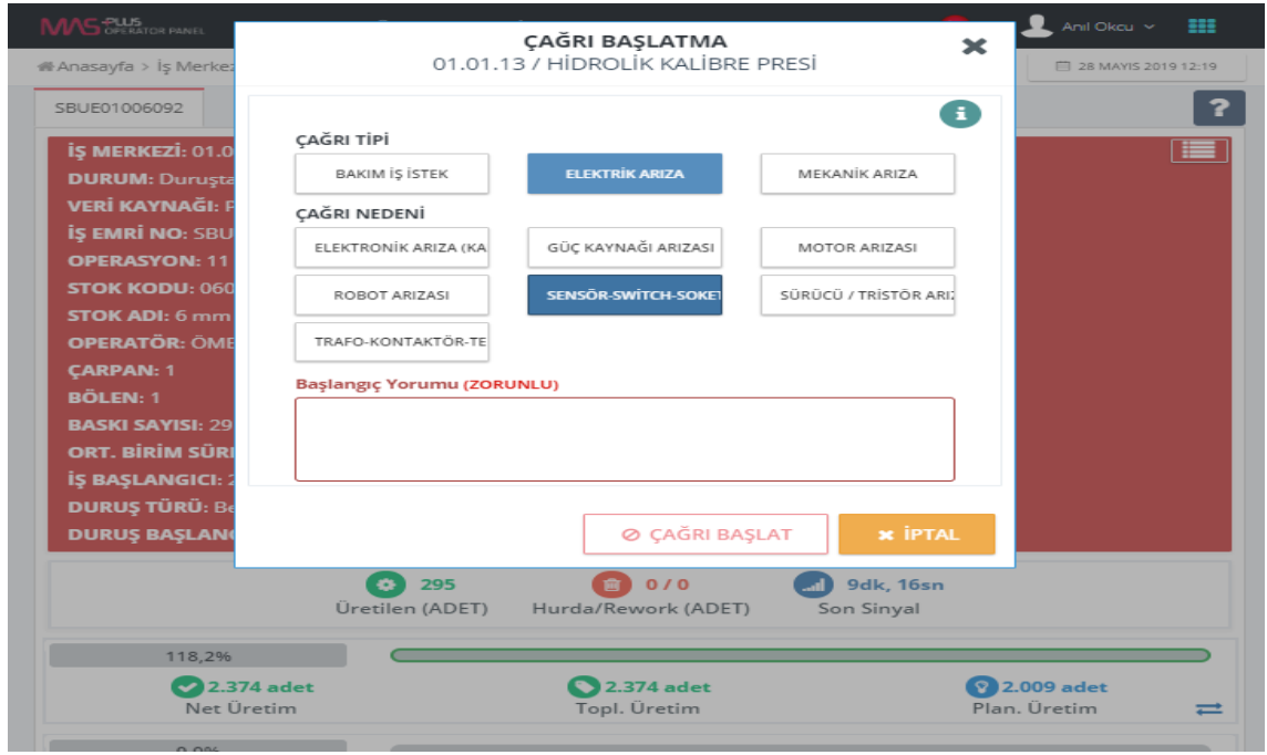
Şekil 3.36. Andon Sistemi Elektrik Arızası Ekranı 4
