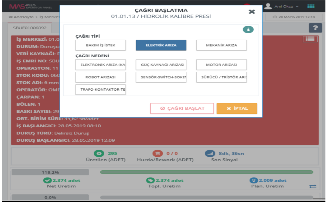
Şekil 3.35. Andon Sistemi Elektrik Arızası Ekranı 3
