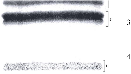
Şekil 4. Sterol ve Triterpenik dialkollerin tespiti için kazınması gereken bölgeleri gösteren pirina yağına ait ince tabaka plakası
