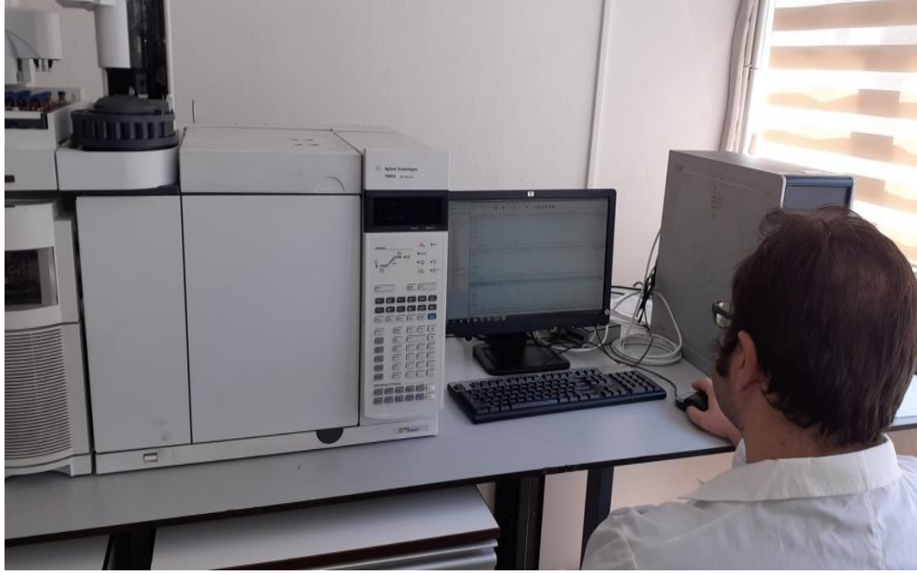
Resim 3.6. Uçucu yağ bileşenlerinin GC/MS cihazında belirlenmesi
