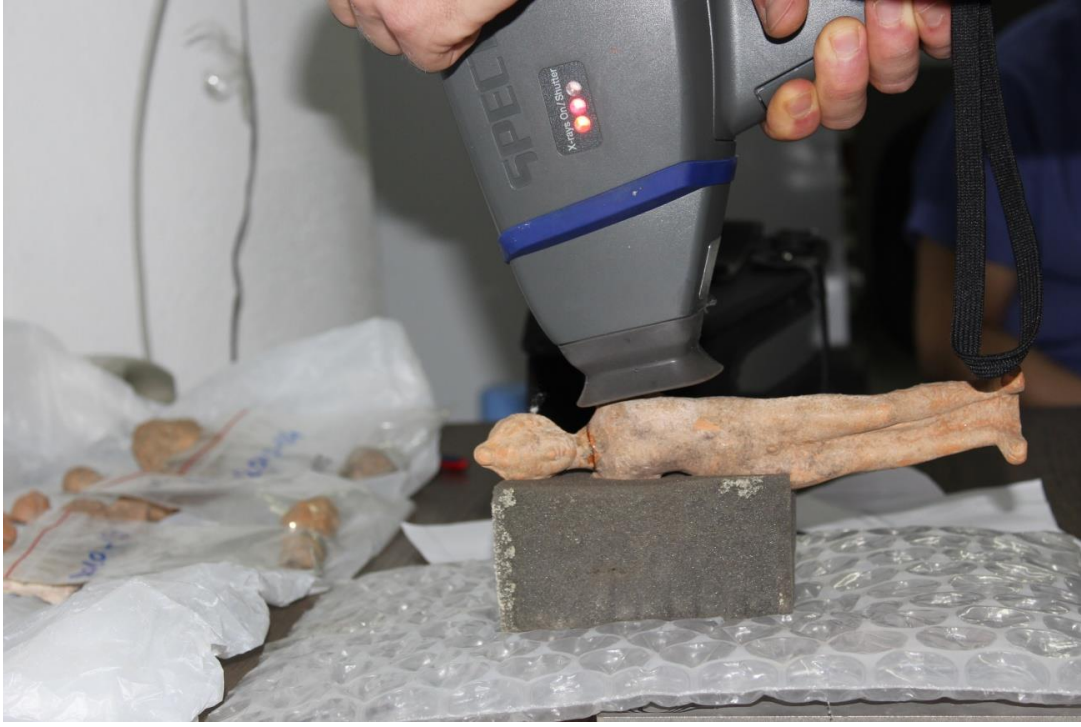
Resim 5. 5. pXRF (Taşınabilir X - Ray Floresansı) Cihazı Yapılan Kimyasal Kil Analizi.
