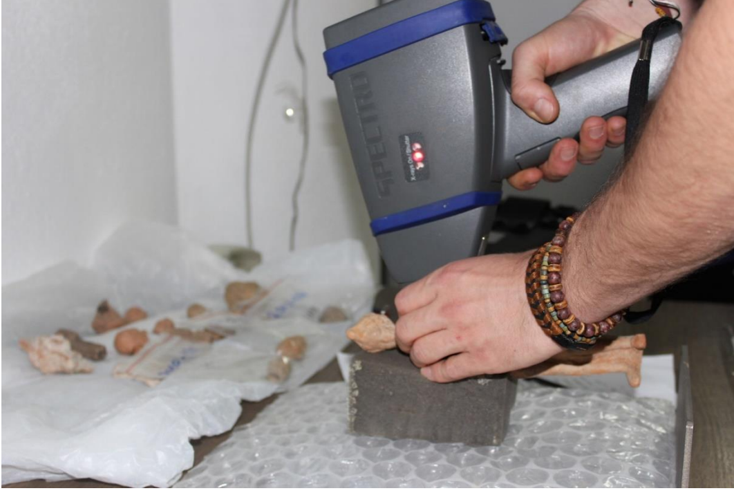
Resim 5.3. pXRF (Taşınabilir X - Ray Floresansı) Cihazı Yapılan Kimyasal Kil Analizi.
