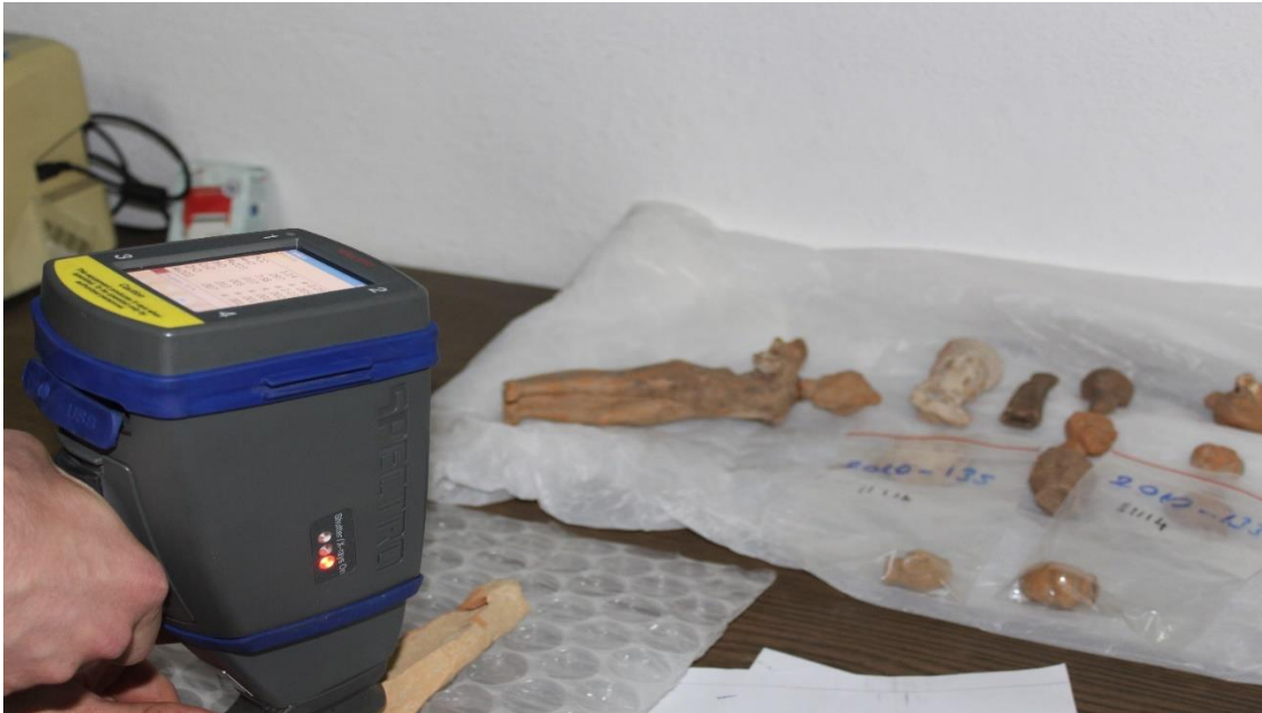
Resim 5. 2. pXRF (Taşınabilir X-Ray Floresansı) Cihazı Yapılan Kimyasal Kil Analizi.
