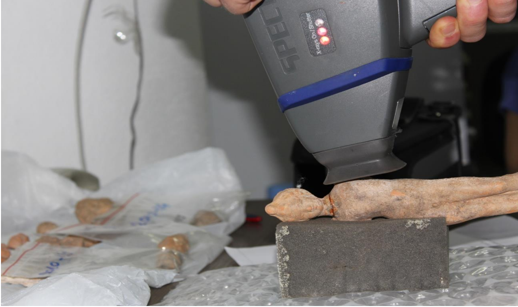
Resim 5. 4. pXRF (Taşınabilir X-Ray Floresansı) Cihazı Yapılan Kimyasal Kil Analizi.
