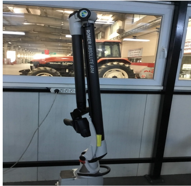
Resim 17. "Romer Absolute Arm" marka entegre tarayıcı sensörlü "7330si" model lazer tarayıcı.
