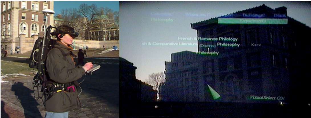
Resim 9. The touring machine cihazı ve elde edilen görüntü.
