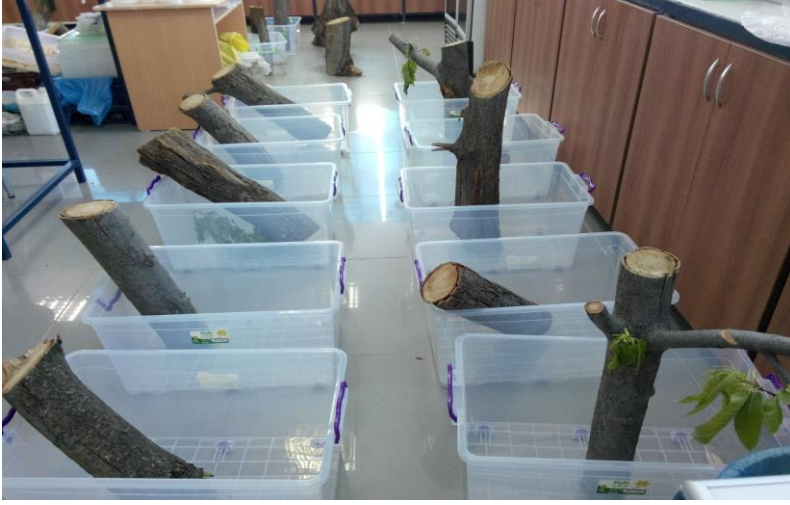
Şekil 3.2. Kestane kütükleriyle hazırlanan deney düzenekleri
