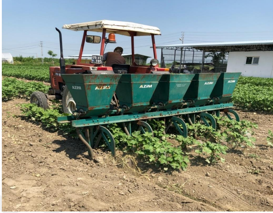
Resim 3.10. Deneme parselleri topraklarına 5 cm derinlikte gübre uygulanırken genel bir görünüş
