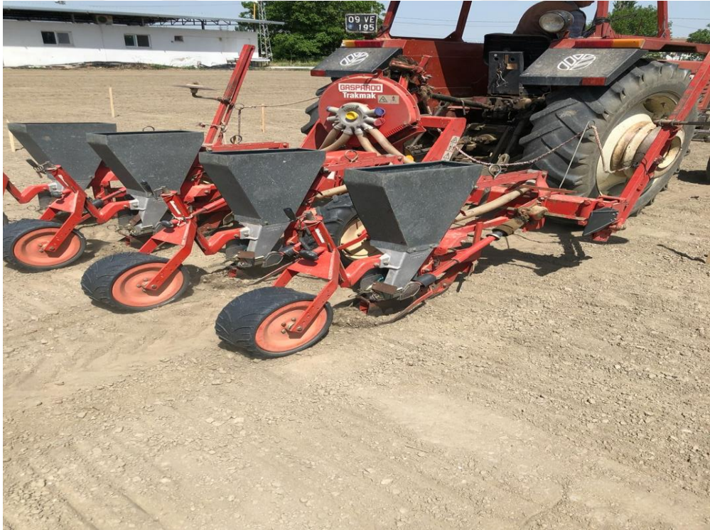
Resim 3.6. Araştırma alanına havalı mibzer ile ekim yapılırken genel bir görünüş
