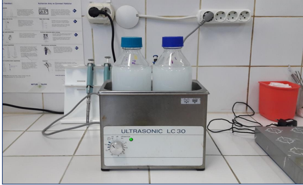
Resim 5. TiO_2 çözültisine sonikasyon işlemi uygulanması
