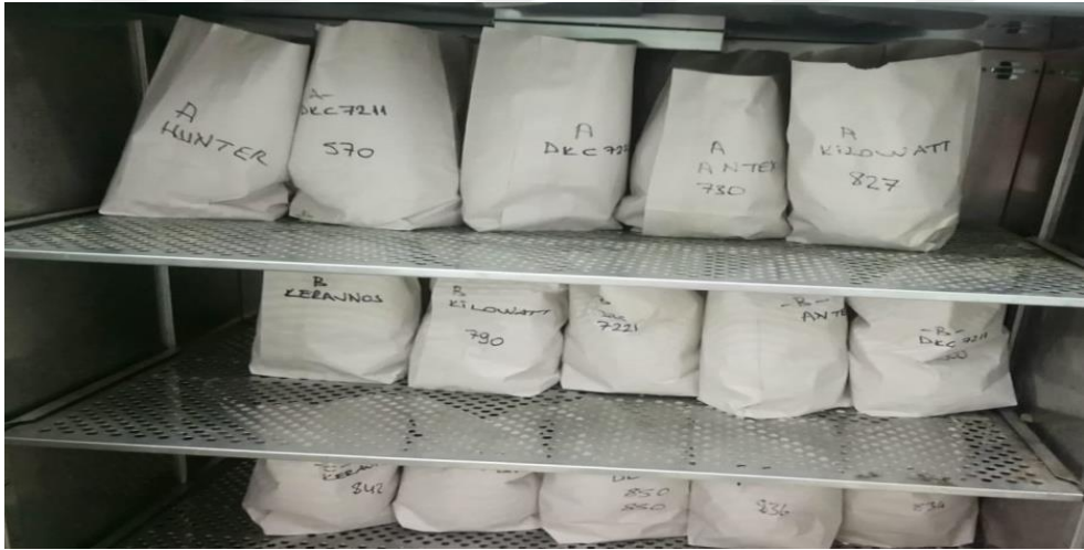
Şekil 3.5. Örneklerin kurutulması için kullanılan etüv cihazı
