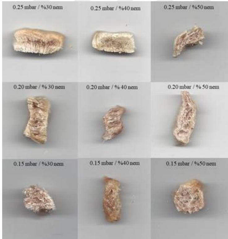
řekil 4.11 Dondurarak n kurutma ve ardından puf kurutma uygulanan rnekların makro yapı grntleri
