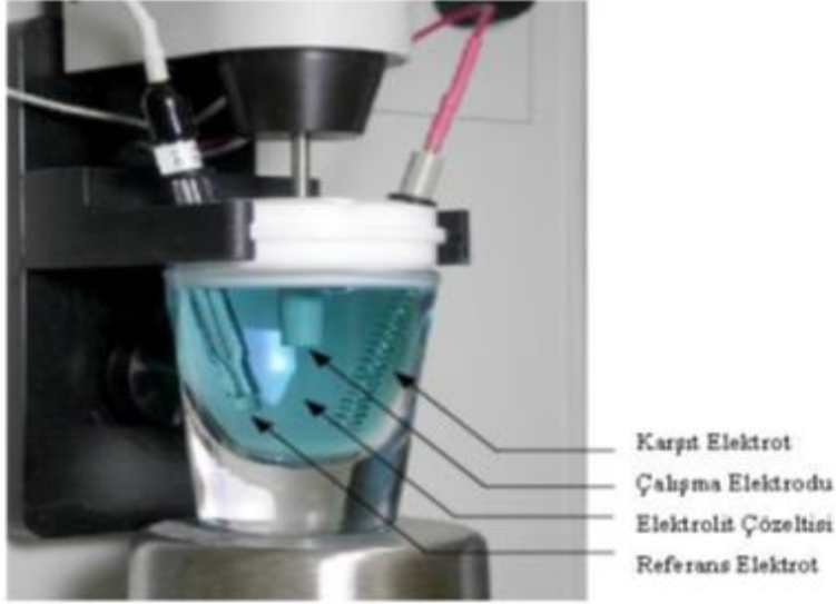
Şekil 1.9. Üç elektrotlu elektrokimyasal hücre
