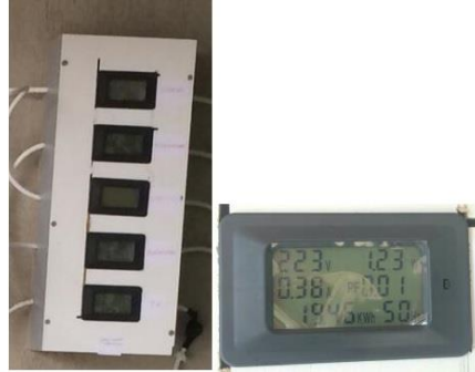
Şekil 3.18. AC Kayıt Cihazının Hibrid Sistemdeki Görünümü
