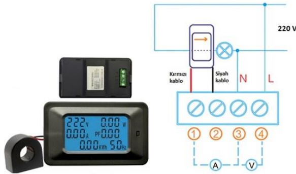
Şekil 3.17. AC Kayıt Cihazı ve Bağlantı Şeması
