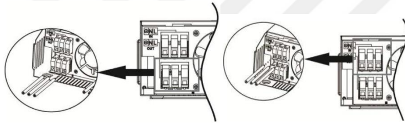
Şekil 3.13. İnverter AC Çıkış Bağlantı Noktası ve İnverter Şebeke Girişi Bağlantı Noktası
