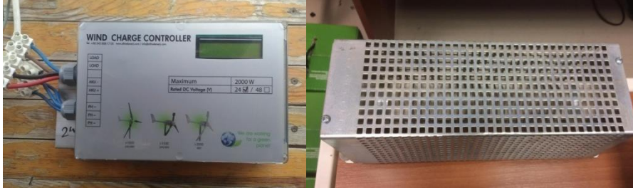
Şekil 3.10. Rüzgar Türbini Şarj Regülatörü ve Upload
