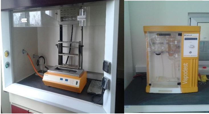
Şekil 3.2. Kjeldahl Protein Tayin Cihazı
