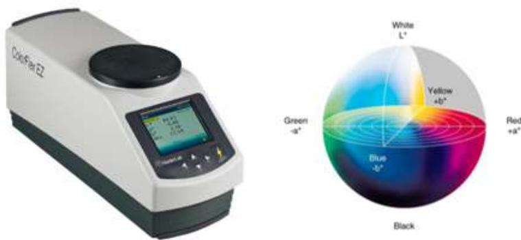
Şekil 3.7. Renk ölçüm cihazı ve renk değişimleri
