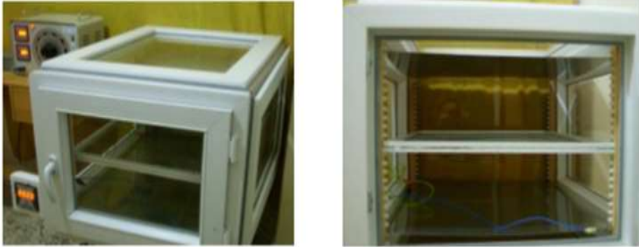
Şekil 3.2. Elektrostatik yükleme kabini
