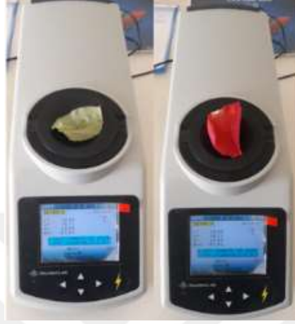
Şekil 3.14. Yaprak ve taç yaprağın renk değişimlerinin ölçümü
