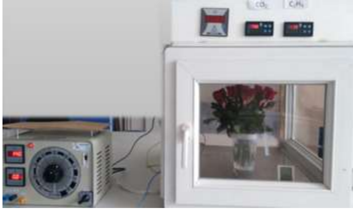
Şekil 3.15. Karbondioksit ve etilen değerlerinin ölçümü
