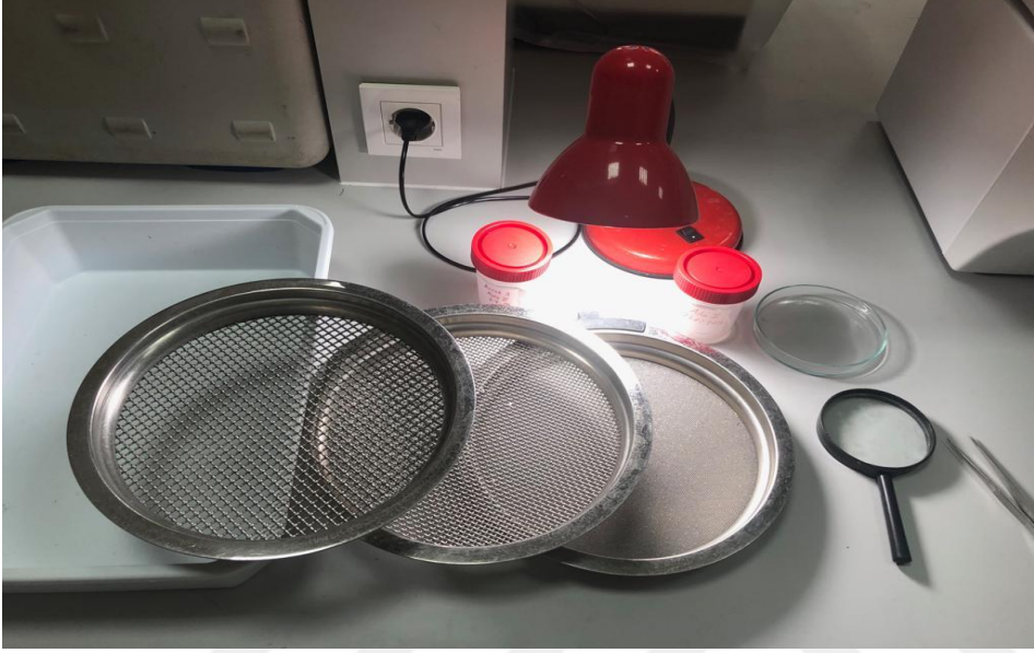
Şekil 3.4. Bentik çamur Örnekleme elekleri (4000-2000-500 \mu\text{m} )
