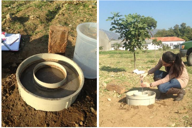
Şekil 3.7. Çift silindirli infiltrometre ve infiltrasyon testi
