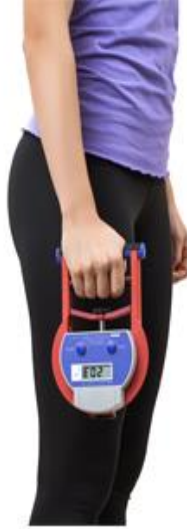
Şekil 19. Takei el dinamometresi
