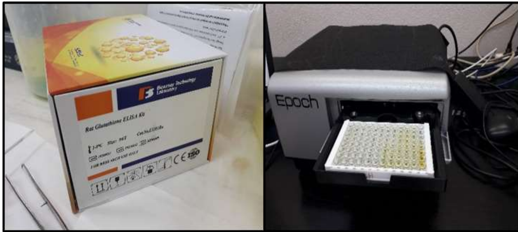
Resim 4. Biyokimyasal analiz çalışma kiti ve analizlerin yapıldığı mikropilaka okuyucu
