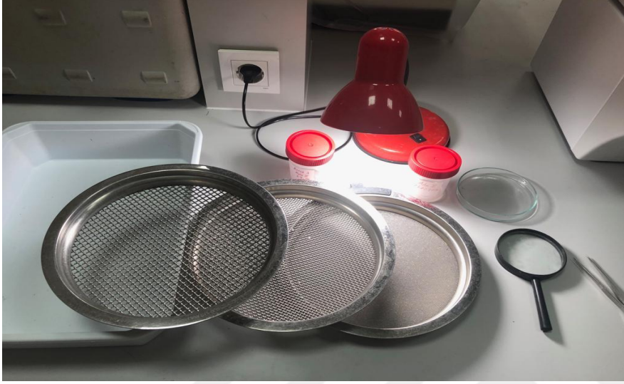
Şekil 3.5. Bentik çamur örnekleme elekleri (4000-2000-500 \mu\text{m} )
