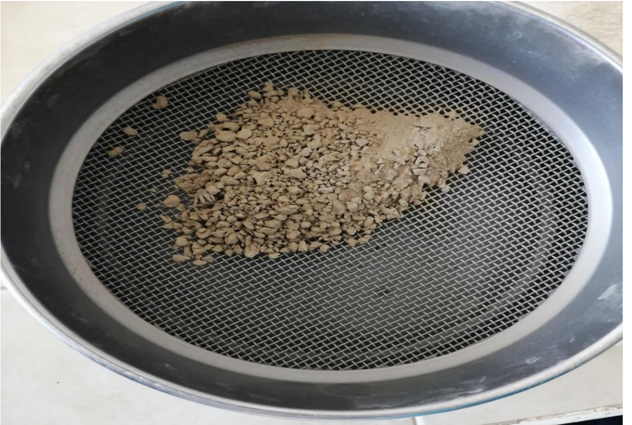
Resim 5. Alınan sediment örneklerinin kurutma işleminden sonra 2 mm'lik elekten geçirilme işlemi.
