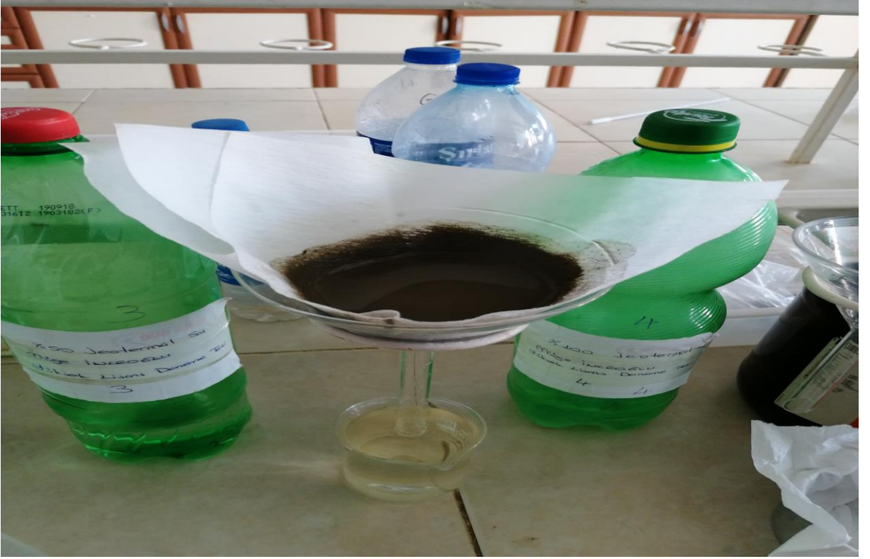
Resim 4. Alınan sediment örneğinin kaba filtre kağıdı ile süzme işlemi.
