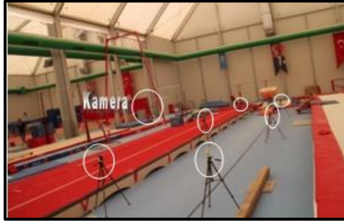
Resim 11. Witty (Microgate, İtalya) Kablosuz Fotosel Sistemi Yerleşimi
