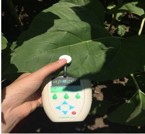
Şekil 3.8. APOGEE CCM-200 plus ile klorofil indeksi ölçümü
