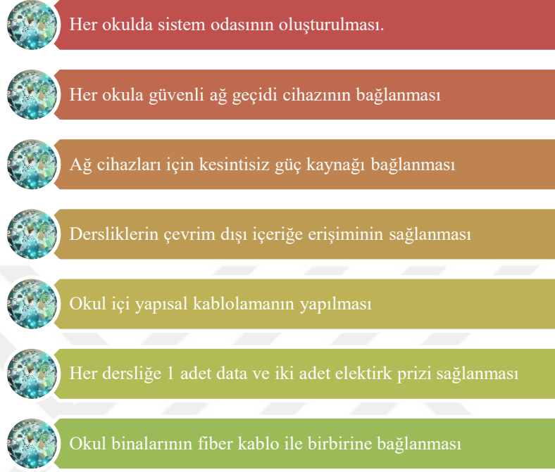
Şekil 2.4. Fatih Projesinde Alt Yapı Hizmetleri (MEB, 2018)
