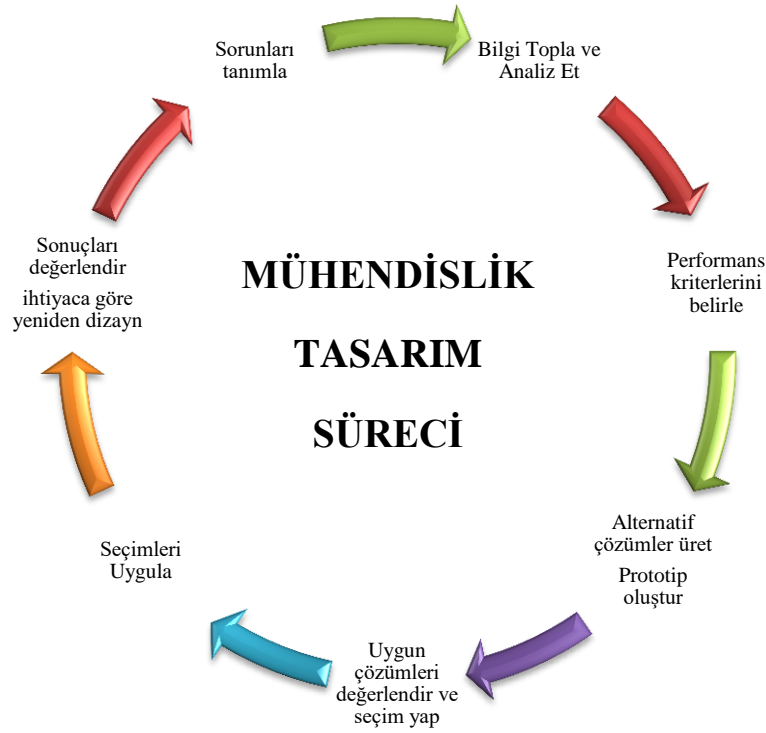
Şekil 1.6. Mühendislik Tasarım Süreci. "Mühendislik Tasarım Süreci", David, McMullan ve Spilka (1997)'nin "Design as a catalyst for learning" adlı kitabından uyarlanmıştır.
