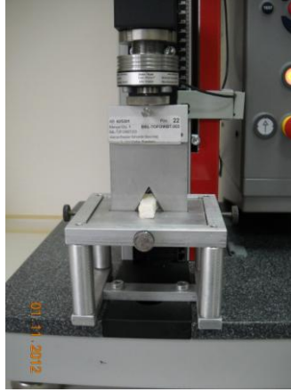
Şekil 3.3. Warner Bratzer yöntemi ile piliç göğüs eti örneklerinin sertliğinin belirlenmesi
