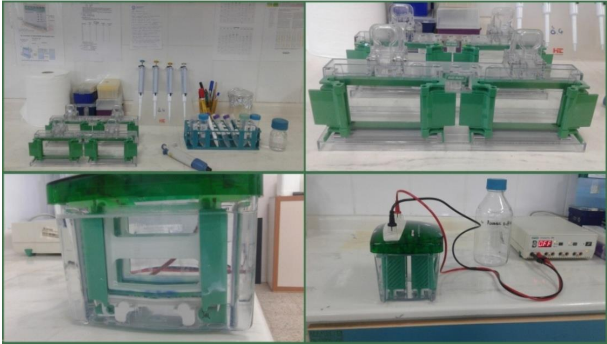
Resim 5. SDS-PAGE jel döküm ekipmanı, solüsyonlar ve elektroferez.
