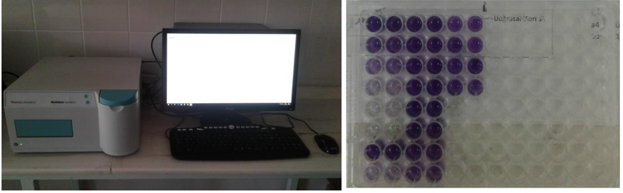
Resim 4. BCA Protein tayini. Multiskan Spectrum ve eliza plate yüklemesi.
