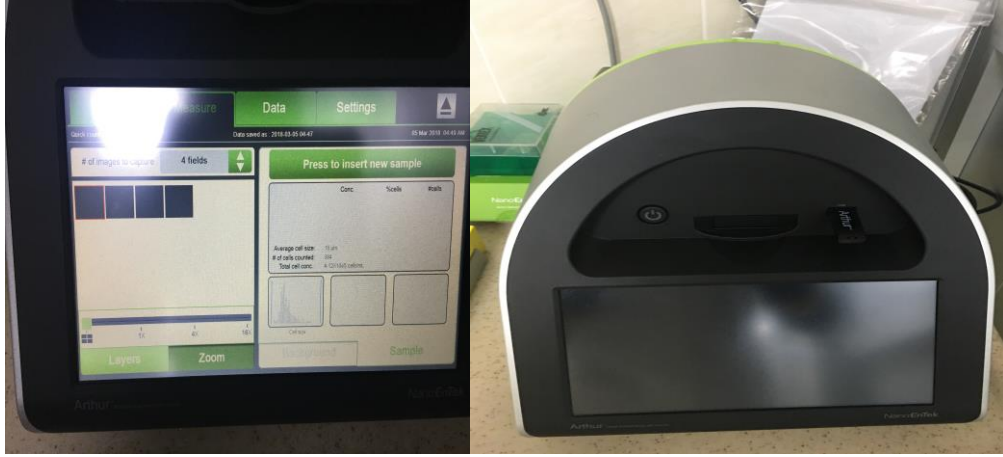
Resim 5. Hücrelerin sayılması (Arthur™ Automated Cell Counter, NanoEnTek)
